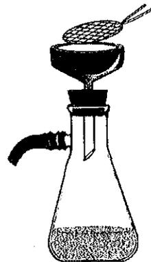
Desensamblar el embudo y retirar la membrana con pinzas estériles
