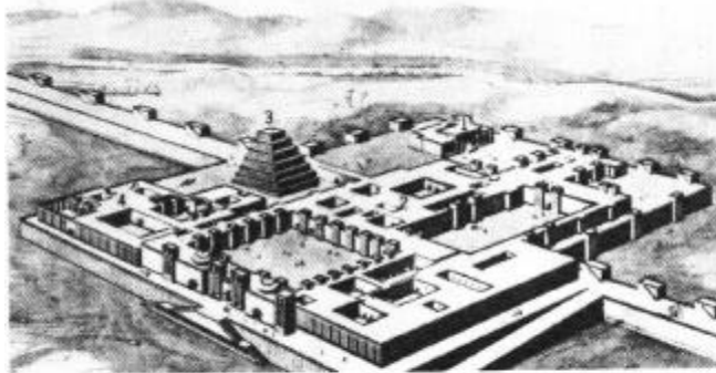
El palacio de Sargón en Khorsabad. Edificado sobre una plataforma elevada, tenía al frente una doble escalera de acceso y una rampa lateral para los carruajes. Observe los muros macizos, sin ventanas. 1. Hilani, sala donde el rey administraba justicia. 2. Salas de gobierno y aposentos del rey. 3. Zíгурat, o templo piramidal. 4. Habitaciones de las mujeres.
