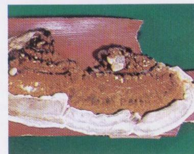
lo largo de los anillos de crecimiento, de tal forma que la madera se disgrega en trazos cúbicos (figura 163). En su última fase se reblandecen las paredes celulares, y la madera, coloreada de oscuro, se reduce fácilmente a polvo.
