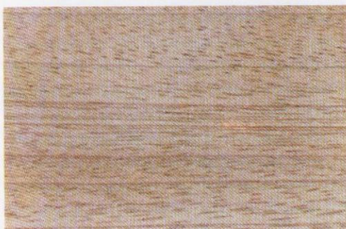
El árbol puede llegar a una altura de 40 metros y a un diámetro de 140 cm, con una densidad, en seco, de 750 kg/m<sup>3</sup> y, en verde, de 850 kg/m<sup>3</sup>.
