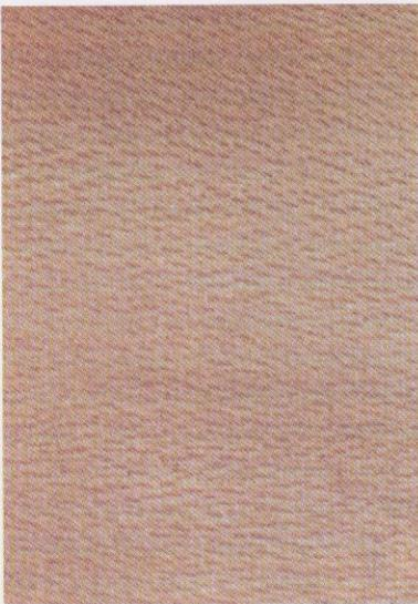
La textura es fina y uniforme y generalmente de fibra recta. Es una madera muy similar al haya cuando está secada al vapor, algo dura y bastante flexible, aunque se carcome con facilidad. Este árbol puede alcanzar una altura media de 25 m y un diámetro de 80 cm, con una densidad, en seco, de  $580 \text{ kg/m}^3$  y, en verde, de  $1.085 \text{ kg/m}^3$ .
