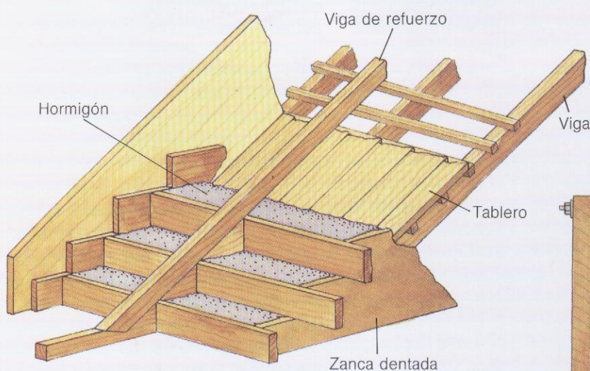
b) Encofrado para una escalera
