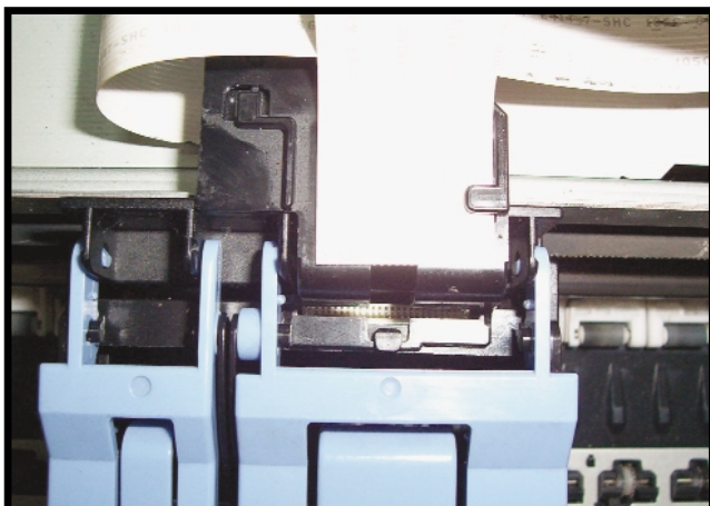
AQUI VEMOS EN PRIMER PLANO EL ZOCALO DONDE SE CONECTA LA CINTA QUE TRANSPORTA LOS DATOS HASTA LOS CABEZALES DE IMPRESION. TAMBIEN VEMOS LA CINTA DETRAS, PROPENSA A CONSTANTES PLIEGUES PRODUCIDOS POR EL TRABAJO DE IMPRESION.
