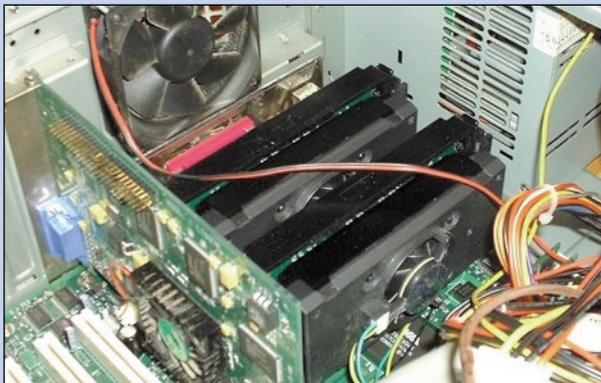
**3** Una vez acoplado el motherboard, procedemos a instalar las dos CPUs (en nuestro caso, en dos Slots 1), con sus respectivos coolers y la memoria RAM. Ya podemos bootear y acceder al BIOS para chequear que esté todo bien.
